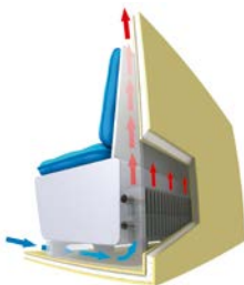
Mit Konvektoren kann die Luftzirkulation ideal erzeugt werden. Ein geschlossener Luftheizungsschlauch tut es aber auch.
