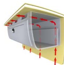
Die Hinterlüftung von Deckenkästen ist relativ einfach möglich.
