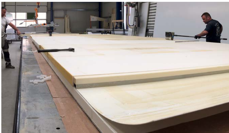
Vorbereitung des Sandwiches aus Schaumkern, Alu- und Hartschaumeinlagen und Deckschichten.
