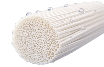
UF – Hohlfasermembran (ca. 0,1 µm - 0,01 µm)
