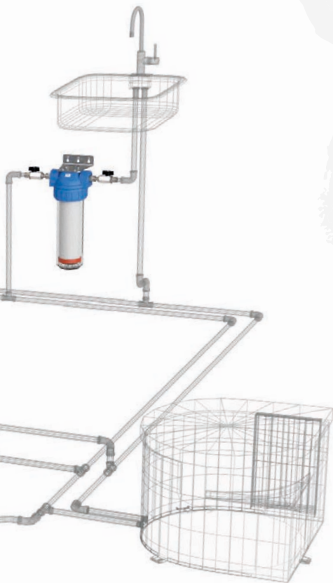
Beispiel Frischwassersystem an Bord
